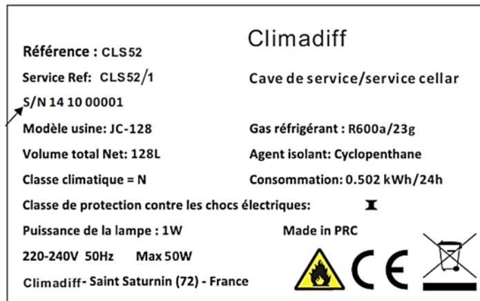
Технические и электрические данные прибора указаны на табличке производителя, прикрепленной к внутренней стенке или в задней части изделия (в зависимости от модели).
