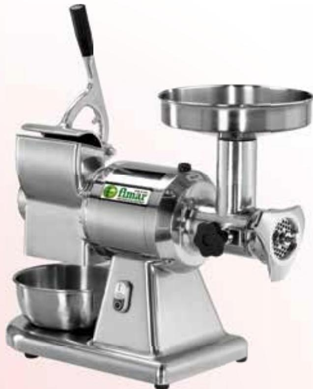
Struttura in alluminio lucidato con trasmisiva in acciaio inox - gruppo macinazione in acciaio inox estraibile - bocca ingresso carne Ø 52 mm - riduttore con ingranaggi a bagno d'olio - in dotazione sistema enterprise con piastra inox (fori Ø 6 mm) e coltello inox autoaffilante. La parte della grattugia è caratterizzata da: bocca in alluminio lucidato - rullo in acciaio inox - griglia inferiore di protezione - microinterruttore leva pressore grattugia.
