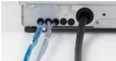
Вставьте кабель сетевого питания с задней стороны машины и протяните в переднюю часть к соединительным клеммам.
