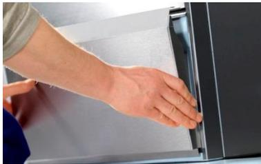
Снимите переднюю обшивку **UC-S**: дополнительно снимите правую боковую обшивку
