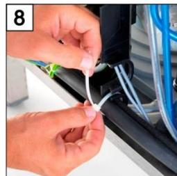
8 Для уменьшения натяжения жил кабеля зафиксируйте кабель сетевого питания на монтажной панели с помощью кабельной стяжки.
