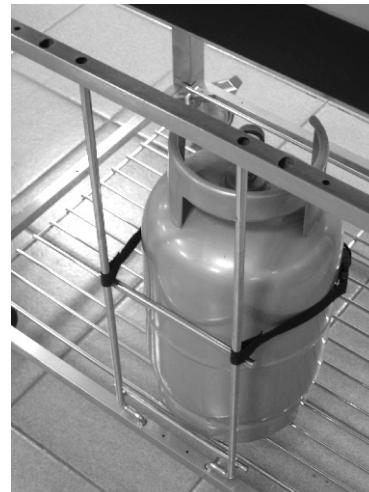
5) Appoggiare la bombola al fondo e fissarla al resto della struttura mediante i tiranti appositi.
