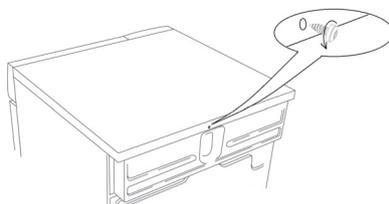
2. Sichern Sie den Kippschutz mit den beiden Schrauben, wie auf dem Bild gezeigt.
