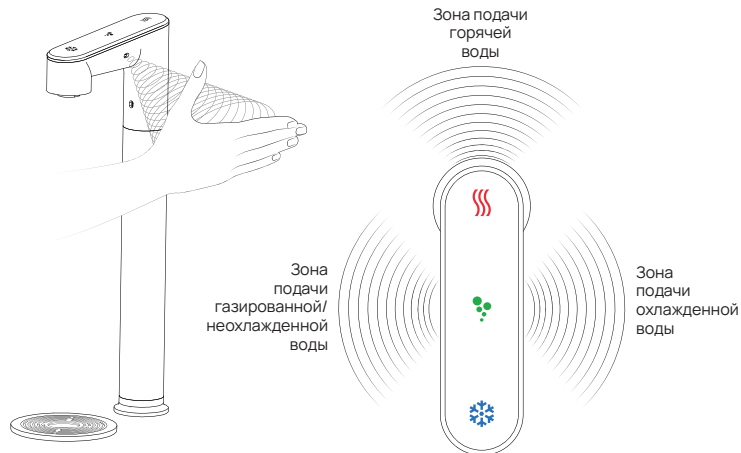
Рис.10. Принцип бесконтактного управления
