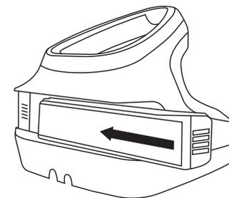
Вы можете зарядить АКБ сканера с помощью зарядно-коммуникационной подставки. Для этого поместите аккумулятор с соответствующий отсек подставки. Индикация указывает на этап заряда.
