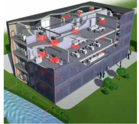
Работа геотермального теплового насоса
