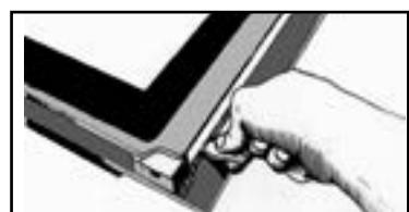
Faites levier sur l'ensemble afin de déclipper le cadre et sa vitre. Effectuez la même opération à gauche.
