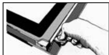
Zdvihnite zostavu na odpojenie rámu a skla. To isté spravte vľavo.
