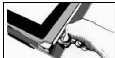
Użyć efektu dźwigni, aby rozłączyć ramę i szybę. Wykonać tę samą czynność z lewej strony.
