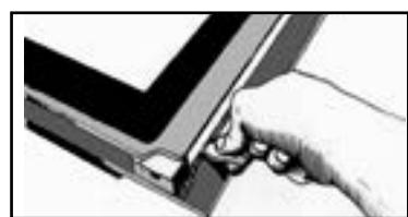
Auf das gesamte Teil eine Hebelwirkung ausüben, um den Rahmen mit der Scheibe auszubauen. Führen Sie denselben Vorgang auf der linken Seite durch.
