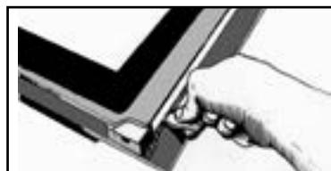
Wip het lijstgeheel en het glas los. Voer dezelfde handeling links uit.
