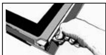
Поднимите как рычагом каркас, чтобы отщелкнуть каркас со стеклом. Выполните аналогичные действия слева.
