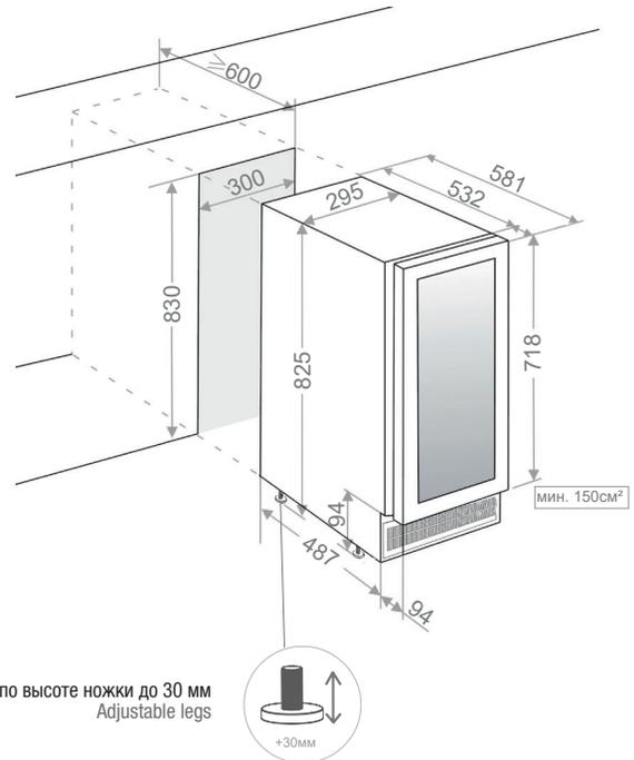
Регулируемые по высоте ножки до 30 мм
