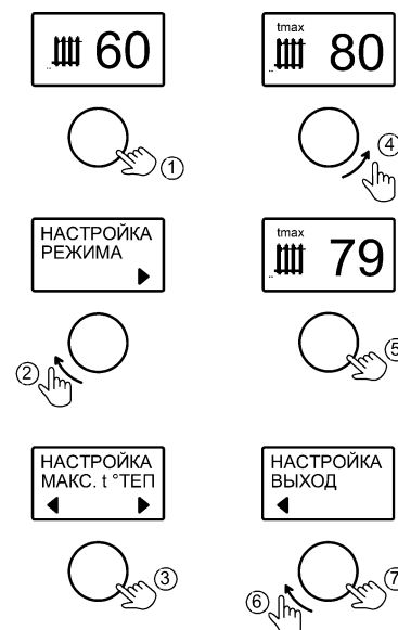
Рисунок 9. Настройка максимальной температуры теплоносителя
