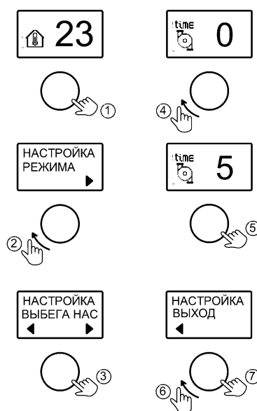
Рисунок 12. Настройка времени выбега насоса
