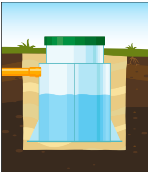
«Экосети» - стандартный подвод коллектора на глубину до 0,6 м по низу трубы
