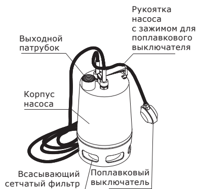
Рис. 1 Конструкция насосов APV.06 / APV.40 V
