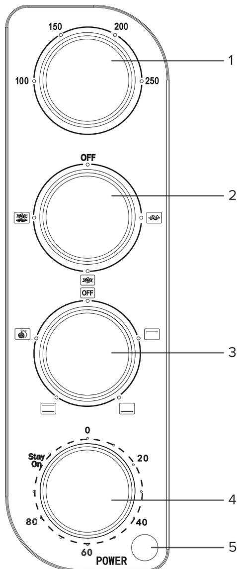
1 — регулятор температуры. Поворотом этой рукоятки регулируется температура приготовления во всех режимах, кроме сушки.
