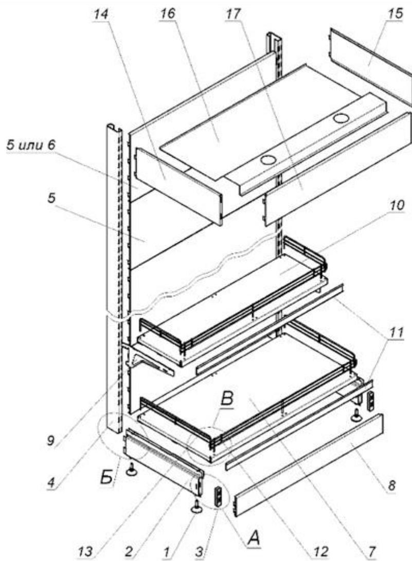
Схема сборки стеллажа прямого СТ1-П
