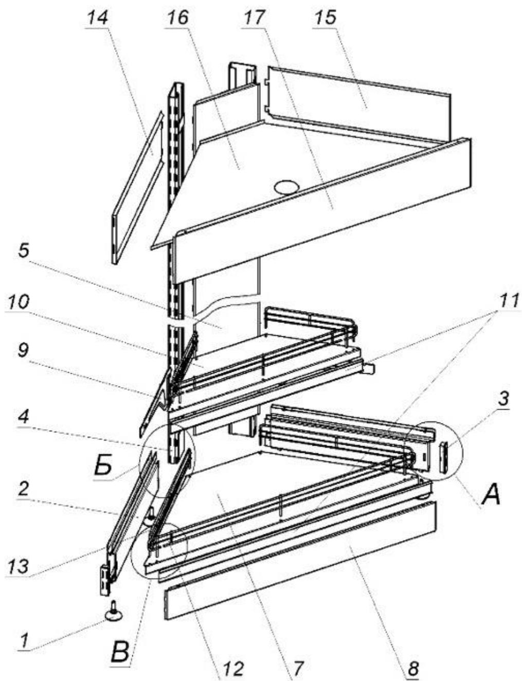
Схема сборки стеллажа углового наружного СТ1-УН
