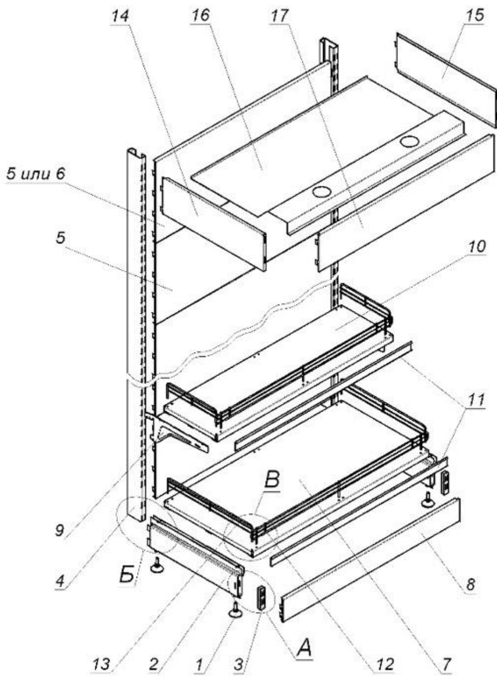
Схема сборки стеллажа прямого СТ1-П
