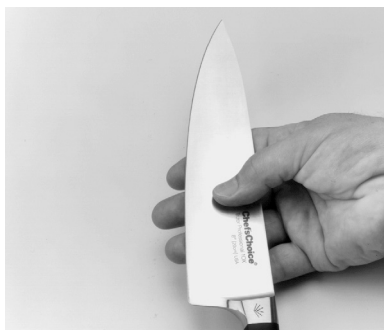
Рисунок 7. Заусенец можно обнаружить, проведя пальцами по лезвию.
