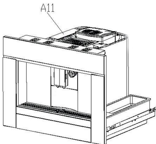
Schritt 6: Öffnen Sie die Tankabdeckung auf der linken Seite von A 11.
