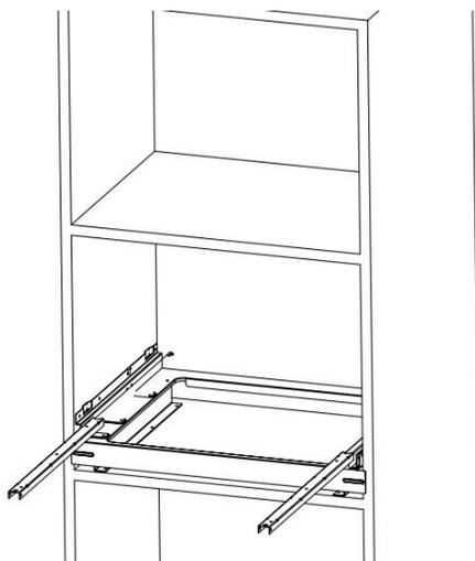
Schritt 4: Befestigen Sie die Kaffeemaschine an der Führung.
