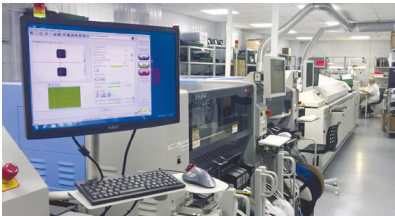
Линии поверхностного монтажа электронных компонентов
