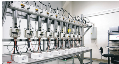
Стенды поверки и тестирования электросчетчиков
