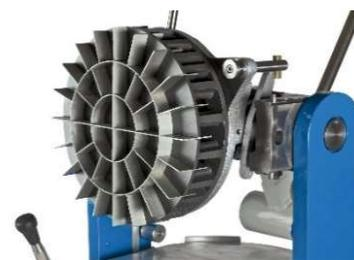
Уникальная система наклона вперед для простого открытия, удобной и безопасной очистки, экономящая время.
