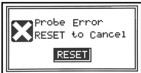
Зонд не подключен или неисправен.
