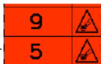
Предупреждающий сигнал обозначается красным цветом. Рабочий цикл прерывается из-за недостаточной температуры нагрева печи. На первой строке дисплея вместо значения температуры отображаются три линии, указывающие на то, что
