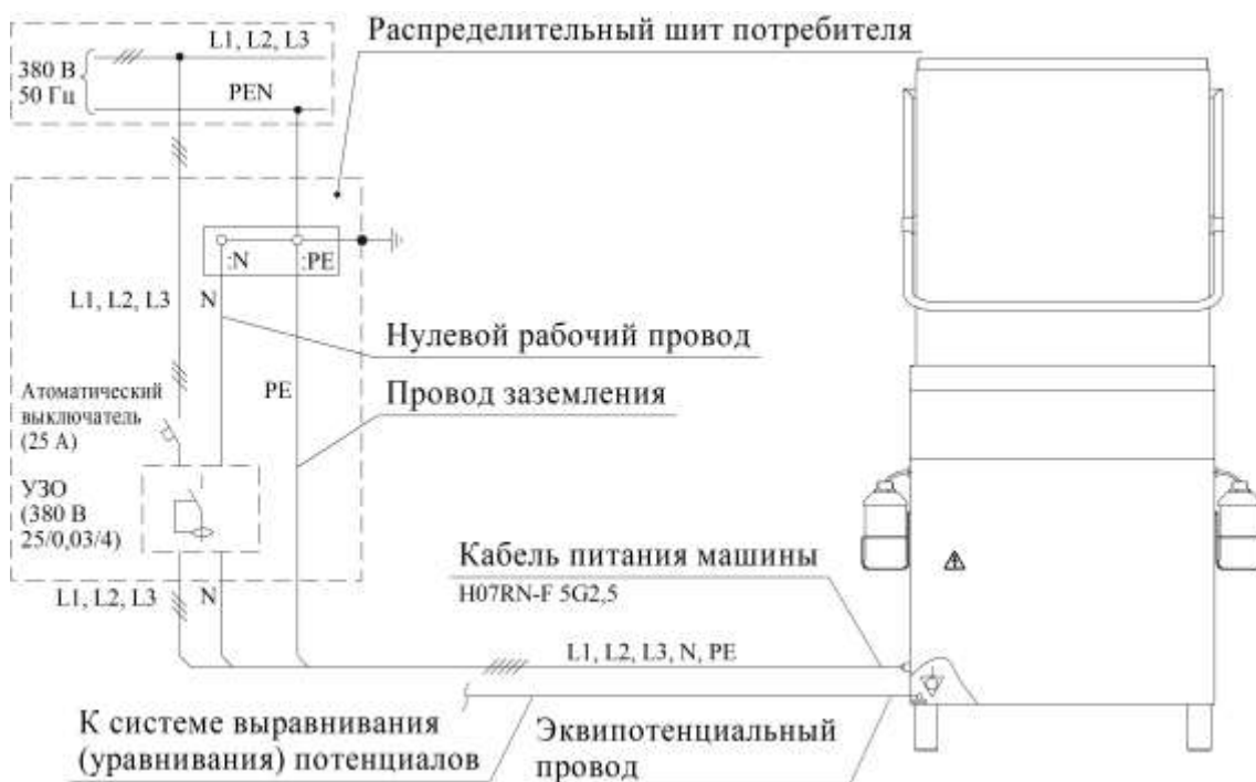
Рисунок 7 – Схема электрическая подключения машины к электрической сети
