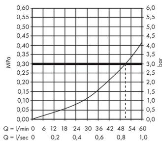
Скрытая часть запорного вентиля, шпindelная, расход воды 52 л/мин, DN 15
