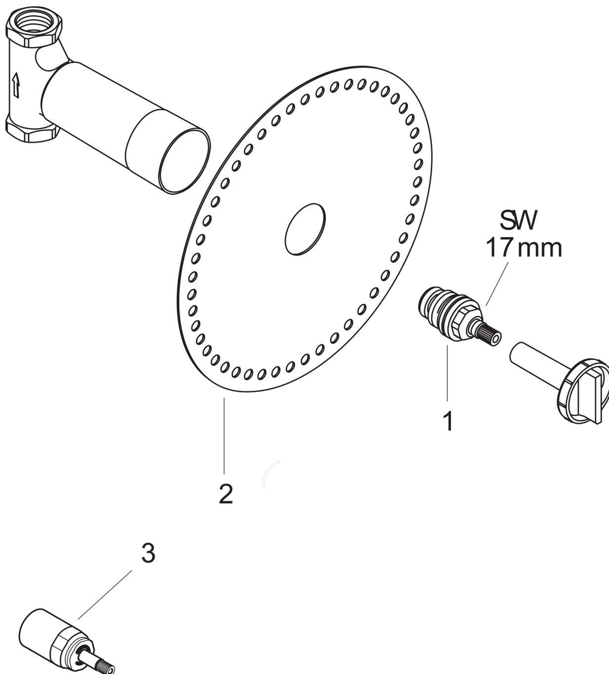
Скрытая часть запорного вентиля, шпindelная, расход воды 52 л/мин, DN 15
