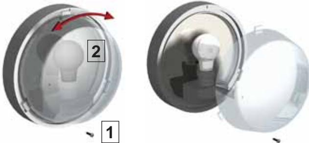
Отвинтите крепящий защитный колпак светильника винт (1) и слегка поверните колпак (2) так, чтобы он вышел из пазов. Вывинтите старую лампочку и поставьте новую лампочку на 60 W. Установите защитный колпак на свое место и зафиксируйте крепящим винтом.
