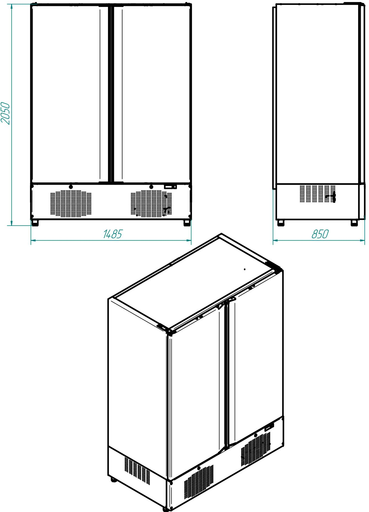
Шкаф холодильный типа ШХ-1,4 (ШХн-1,4; ШХс-1,4) с нижним расположением агрегата предназначен для хранения пищевых продуктов в охлаждённом или замороженном состоянии на предприятиях общественного питания и торговли.
