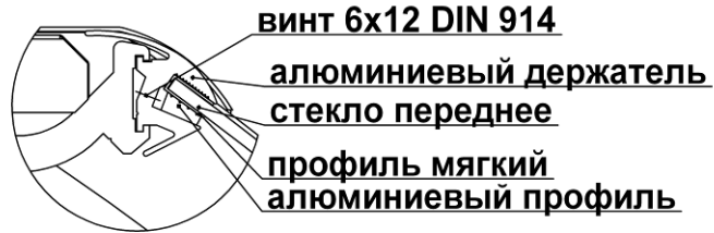
Б (Схема крепления для стекла поз. 26. Схема крепления для стёкол из комплектов поз. 19 и 20 аналогична)
