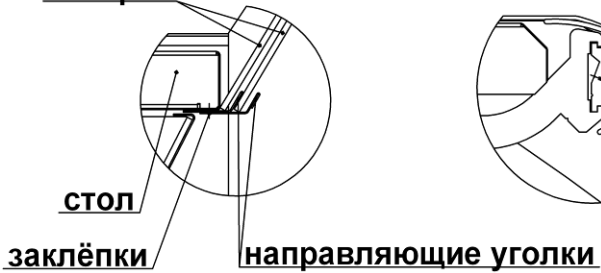
А (Схема крепления комплекта поз. 21) створки
