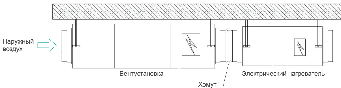
Монтаж электрического нагревателя
