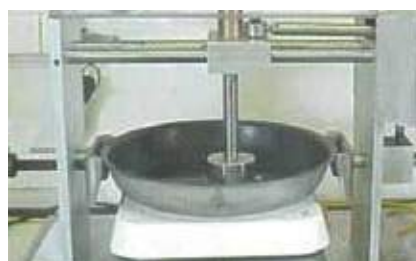
Test di abrasione con carta vetrata a 4,5 o 1,5 Kg Abrasion test with sandpaper with 4.5 or 1.5 kg
