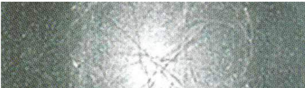
Normale rivestimento a tre mani indice di resistenza ai graffi = 5. Three-layer traditional coating; index of resistance to scratching: 5.
