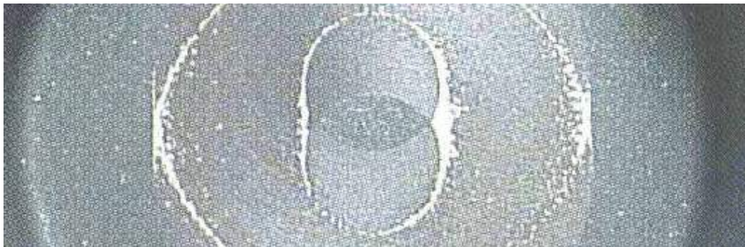
Normale rivestimento a tre mani - Indice di resistenza all'abrasione = 5 misurata dopo 90 minuti. Traditional three layer coating - Abrasion resistance index = 5 measured after 90 minutes.
