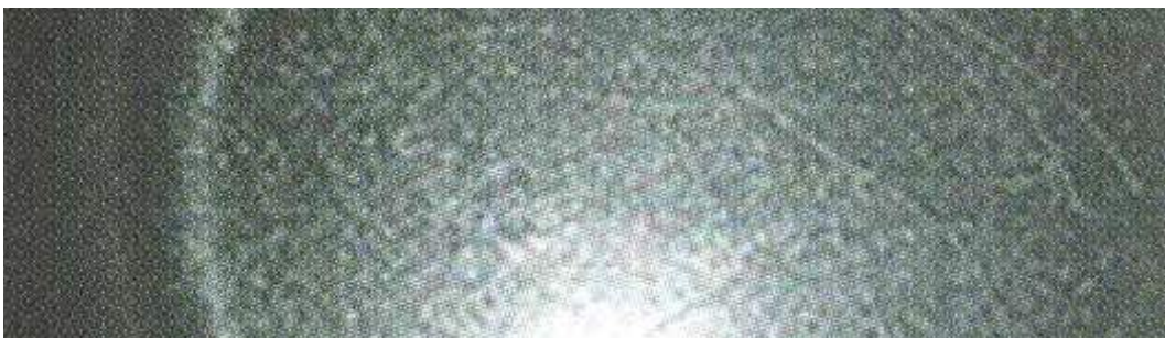
Teflon® Platinum indice di resistenza ai graffi 7-8. Teflon® Platinum, index of resistance to scratching: 7-8.
