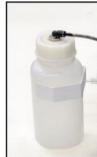
Abb. 5: Überprüfen des Kondensatauffangbehälter
