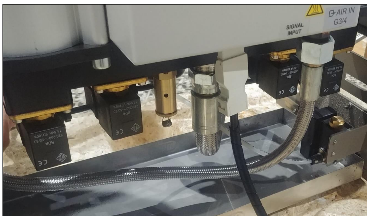
Rys. 8: Prawidłowe prowadzenie węża
