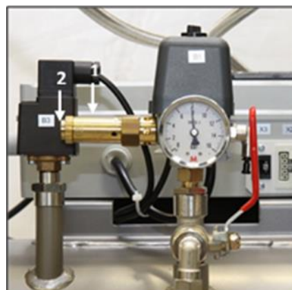
Rys. 22: Kontrola zaworu bezpieczeństwa
