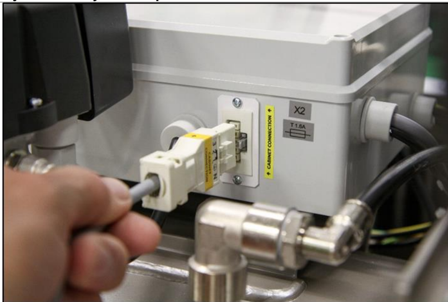
Obr. 18: Zapojenie skrinky ku kompresoru
