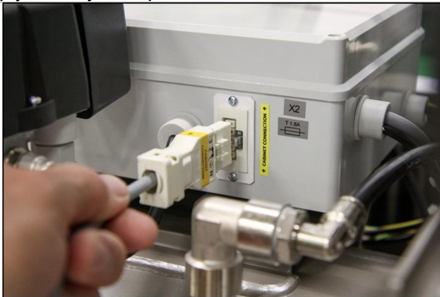
Obr. 18: Zapojení skříňky ke kompresoru
