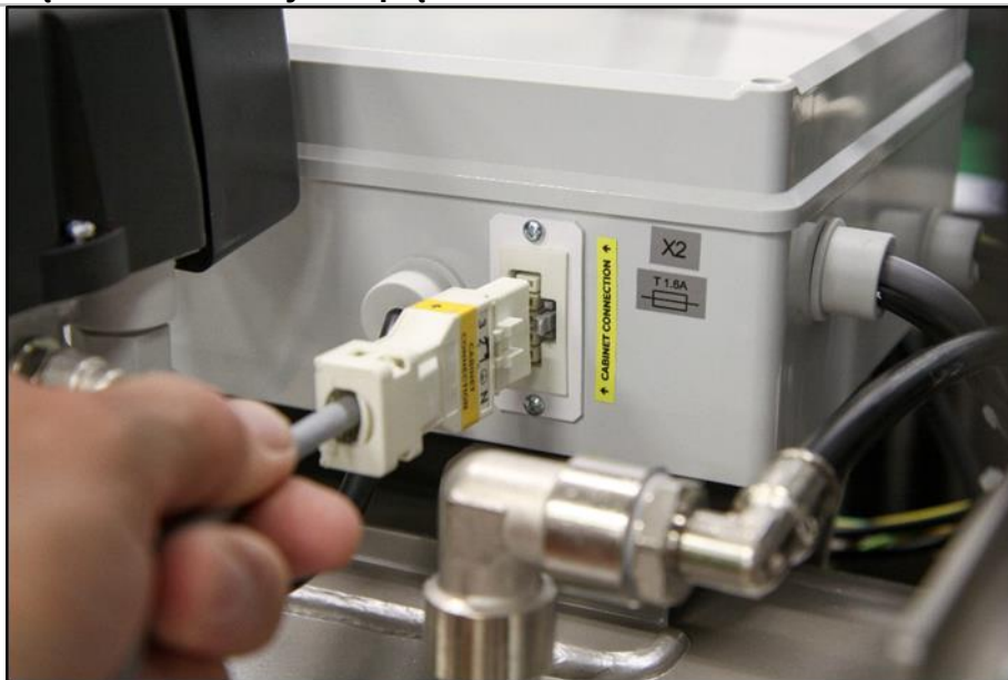
Rys. 18: Podłączenie obudowy do sprężarki
