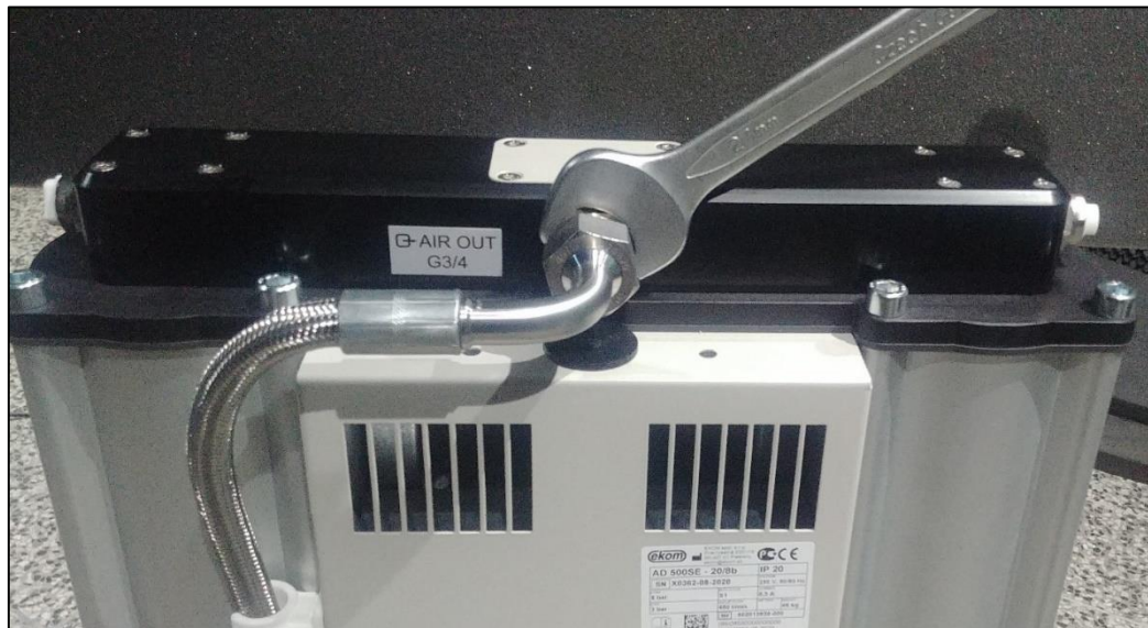
Rys. 10: Wylot sprężonego powietrza
