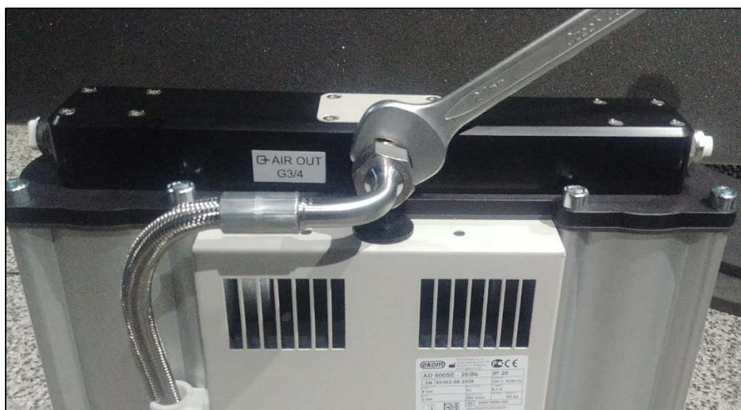
Fig. 10: Sortie d'air comprimé
