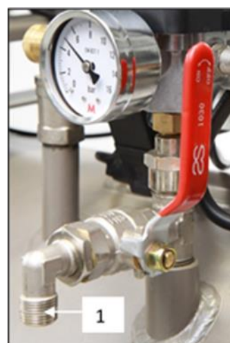
Abb. 14: Anschluss an den Druckluftausgang
