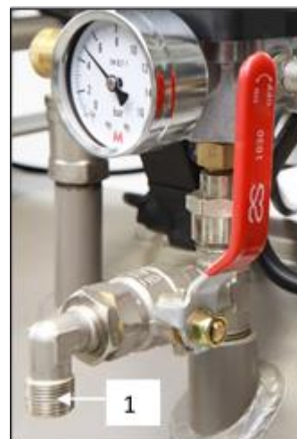
Рис. 14: Подключение к выпускному воздуховоду сжатого воздуха
