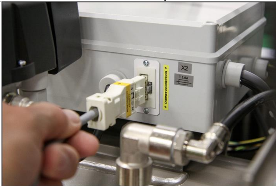
Abb. 18: Anschließen des Gehäuses an den Kompressor
