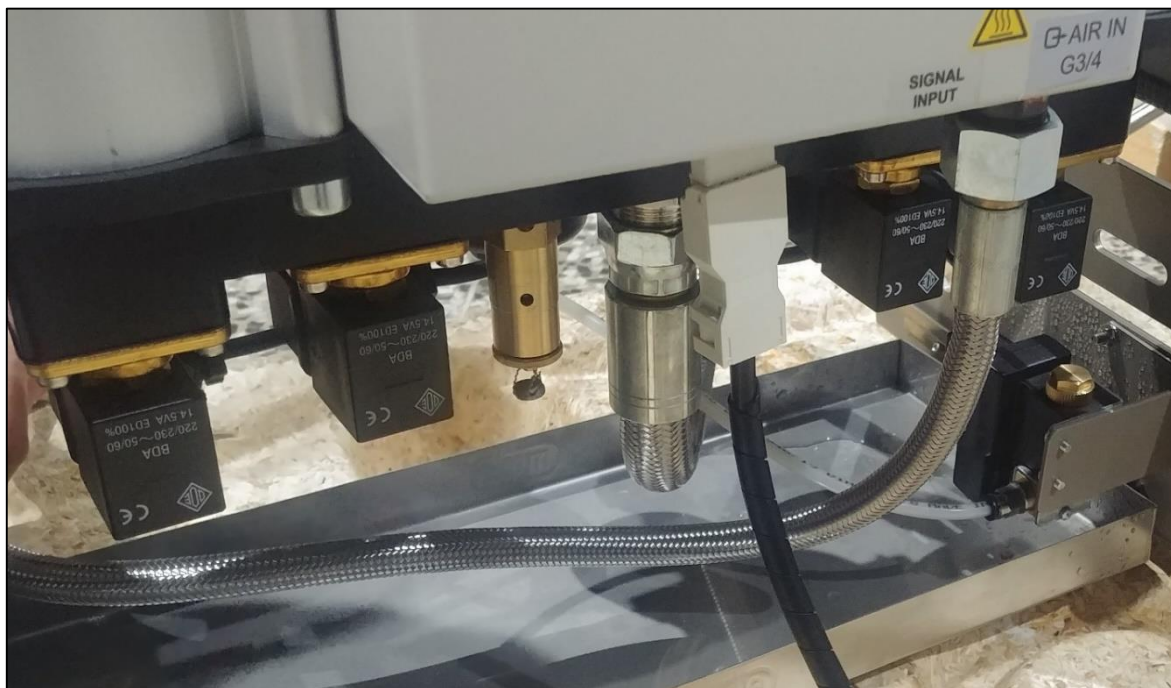
Fig. 8: Acheminement correct des tuyaux
