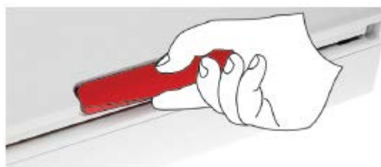
Рисунок 3: Поднимите крышку. Нажмите на центр красной рукоятки большим пальцем и поднимите ее указательным пальцем.
