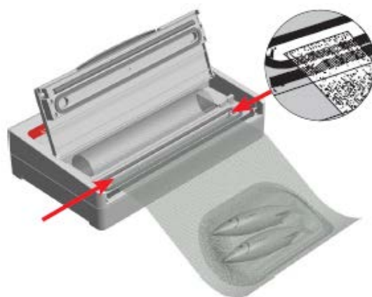
Рисунок 6: Для вакуумной упаковки поместите наполненный пакет в центр вакуумного канала (между черными уплотнителями из пеноматериала).
