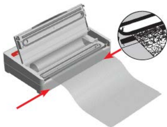
Рисунок 5: Поместите рулон на запечатывающую планку и растяните его до черной прокладки, чтобы запечатать.
