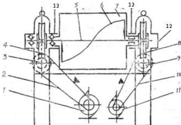
Принцип действия тестомесильной машины — емкость для приготовления теста (дежа) имеет горизонтальный вал, на котором размещены лопасти в форме S или Лопасти. За счёт вращения лопастей происходит смешивание продуктов и приготовление теста. Степень приготовления оператор определяет визуально.
