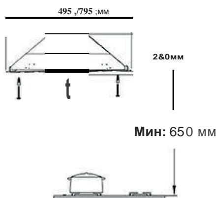
**Подготовка к сборке:** Ознакомьтесь с данной схемой для оптимальной установки вытяжки в кухонном пространстве.
