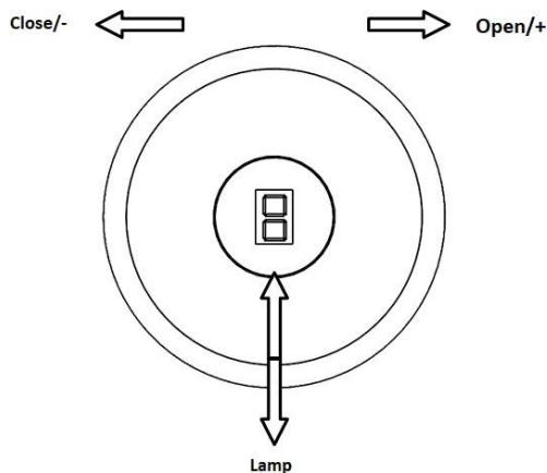
**Lamp button - Кнопка включения освещения:** Вы можете осветить зону приготовления пищи нажатием данной кнопки.
