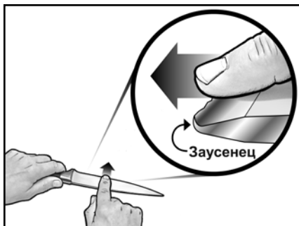
Рисунок 6. Появление отчетливого заусенца на лезвии ножа, перед тем, как переходить к шлифовке в слоте 3.
