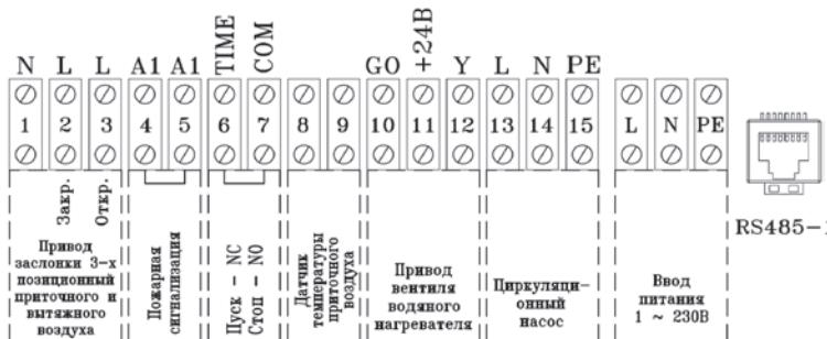
Подключить пульт управления соединительным кабелем в соответствующее гнездо блока управления (RS 485-1). Кабель входящий в состав комплекта к пульту не экранирован.
