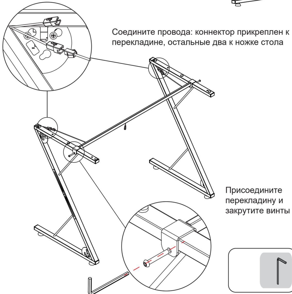
Соедините провода: коннектор прикреплен к перекладине, остальные два к ножке стола
