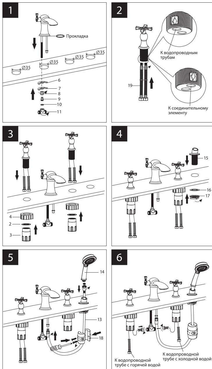
**7)** Шланги для воды, вкрученные в рукоятки со сторон с обозначением стрелок «вверх» (см. пункт 2), присоедините к водопроводным трубам, руководствуясь принципом: левая рукоятка отвечает за регулировку горячей воды, а правая – холодной.
