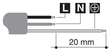
Применяйте исключительно кабель типа H05V2V2-F или аналогичный, рассчитанный на максимальную температуру  $90^\circ\text{C}$ . Замена должна производиться специалистом, который должен выполнять подключение к сети согласно приведенной ниже схеме.
