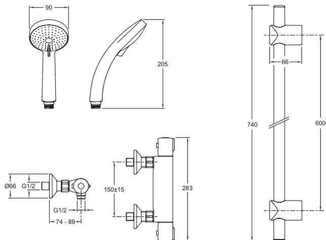
Спецификация продукта: Душевой комплект с термостатическим смесителем. E5493. Коллекция: JULY. РАЗМЕРЫ (СМ): 35 x 64 x 9,50 см. ВЕС: 3,5 кг. ТИП УСТАНОВКИ: Крепление к стене. АКСЕССУАРЫ: 0. НАЛИЧИЕ СМЕСИТЕЛЯ: СО СМЕСИТЕЛЕМ. ОДНОРЫЧАЖНЫЙ СМЕСИТЕЛЬ: МЕХАНИЧЕСКИЙ. КЛАССИФИКАЦИЯ: МЕХАНИКА. ФОРМА ВЕРХНЕГО ДУША: 0. ПЕРЕКЛЮЧАТЕЛЬ: 0. ТИП ШЛАНГА: 0. Термостатический настенный смеситель для душа July (E8455) включает: механизм экономии воды, максимальная температура 50°C.
