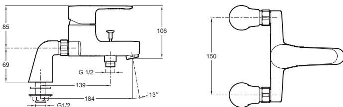
Спецификация продукта: Однорычажный смеситель устанавливаемый на деку для ванны/душа. E16043-4. Коллекция: JULY. ВЕС: 2,4 кг. ТИП: Однорычажный. РАСХОД ВОДЫ: 20 л/мин при давлении 3 бар. МЕХАНИЗМ: Картридж с регулируемым ограничителем температуры. РАЗМЕТКА ОТВЕРСТИЙ: 150 мм. ЭКОНОМИЧНОЕ ПОТРЕБЛЕНИЕ: Экономия воды и энергии. СЛИВ: Без донного клапана. ОДНОРЫЧАЖНЫЙ СМЕСИТЕЛЬ: ОДНОРЫЧАЖНЫЙ СМЕСИТЕЛЬ. УСТАНОВКА: 2 отверстия. ГАРАНТИЯ НА ОТДЕЛКУ: 10 лет.
