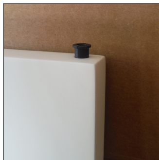
2. Insérer les douilles en plastique dans les trous du cadre.
