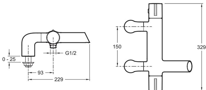
Спецификация продукта: Термостатический смеситель для ванны/душа. E9095. Коллекция: ТООВИ. ВЕС: 3,8 кг. ТИП: Термостатический. РАСХОД ВОДЫ: 19 л/мин. МЕХАНИЗМ: Термостатический картридж. РАЗМЕТКА ОТВЕРСТИЙ: 150 ± 15 мм. СЛИВ: 0. ОДНОРЫЧАЖНЫЙ СМЕСИТЕЛЬ: ТЕРМОСТАТИЧЕСКИЙ ОДНОРЫЧАЖНЫЙ СМЕСИТЕЛЬ. УСТАНОВКА: 0. ГАРАНТИЯ НА ОТДЕЛКУ: 0.
