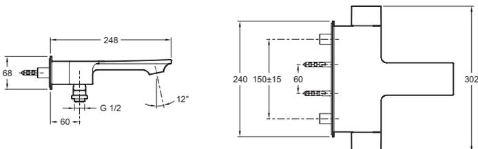
Спецификация продукта: Настенный двурычажный смеситель для ванны/душа. E9100. Коллекция: STANCE. ВЕС: 4,2 кг. ТИП УСТАНОВКИ: Крепление к стене. ТИП: Двурычажный. РАСХОД ВОДЫ: 21 л/мин. РАССТОЯНИЕ МЕЖДУ ЦЕНТРОМ ИЗЛИВА И ЦЕНТРАЛЬНОЙ ОСЬЮ КОРПУСА: 188 мм. ПОДКЛЮЧЕНИЕ: С настенными крепежами и кольцами. МЕХАНИЗМ: Кран-буксы с керамическим диском. СЛИВ: 0. ОДНОРЫЧАЖНЫЙ СМЕСИТЕЛЬ: 0. УСТАНОВКА: Настенные. ГАРАНТИЯ НА ОТДЕЛКУ: 10 лет. Аэратор с антиизвестковым покрытием. Обратный клапан в комплекте.
