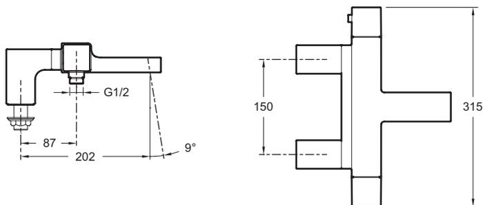
Спецификация продукта: Термостатический смеситель для ванны/душа. E9129. Коллекция: STRAYT. ВЕС: 3,5 кг. ТИП: Термостатический. РАСХОД ВОДЫ: 20 л/мин. РАССТОЯНИЕ МЕЖДУ ЦЕНТРОМ ИЗЛИВА И ЦЕНТРАЛЬНОЙ ОСЬЮ КОРПУСА: 202 мм. МЕХАНИЗМ: Термостатический картридж. РАЗМЕТКА ОТВЕРСТИЙ: 150 мм. СЛИВ: 0. ОДНОРЫЧАЖНЫЙ СМЕСИТЕЛЬ: ТЕРМОСТАТИЧЕСКИЙ ОДНОРЫЧАЖНЫЙ СМЕСИТЕЛЬ. УСТАНОВКА: 0. ГАРАНТИЯ НА ОТДЕЛКУ: 10 лет.
