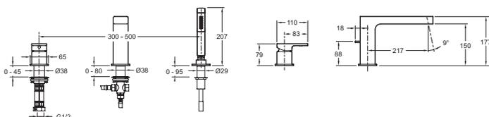
Спецификация продукта: Смеситель для ванны/душа на три отверстия. E37337. Коллекция: STRAYT. ВЕС: 6,4 кг. ТИП: Однорычажный. ВЫСОТА ПОД ИЗЛИВОМ: 177 мм. РАССТОЯНИЕ МЕЖДУ ЦЕНТРОМ ИЗЛИВА И ЦЕНТРАЛЬНОЙ ОСЬЮ КОРПУСА: 217 мм. МЕХАНИЗМ: Керамический картридж. СЛИВ: 0. ОДНОРЫЧАЖНЫЙ СМЕСИТЕЛЬ: ОДНОРЫЧАЖНЫЙ СМЕСИТЕЛЬ. УСТАНОВКА: На борт ванны. ГАРАНТИЯ НА ОТДЕЛКУ: 10 лет. Подводка для душа, нержавеющая сталь 1.80 см.
