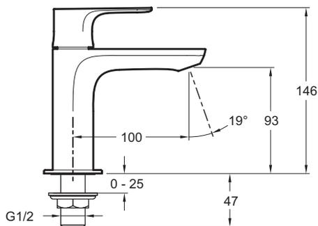
Спецификация продукта: Кран холодной воды для раковины. E72326. Коллекция: ALEO+. ВЕС: 0,8 кг. РАСХОД ВОДЫ: 5 л/мин. ВЫСОТА ПОД ИЗЛИВОМ: 146 мм. РАССТОЯНИЕ МЕЖДУ ЦЕНТРОМ ИЗЛИВА И ЦЕНТРАЛЬНОЙ ОСЬЮ КОРПУСА: 100 мм. МЕХАНИЗМ: Кран-букса с керамическим диском на 1/4 оборота. СЛИВ: Без донного клапана. МОДЕЛЬ СМЕСИТЕЛЯ ДЛЯ КУХНИ: Механика. ОДНОРЫЧАЖНЫЙ СМЕСИТЕЛЬ: 0. УСТАНОВКА: 1 отверстие. ГАРАНТИЯ НА ОТДЕЛКУ: 10 лет. Встроенный аэратор с антиизвестковым покрытием.
