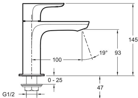
Спецификация продукта: Кран холодной воды для раковины. E72288. Коллекция: ALEO. ВЕС: 1 кг. ТИП: Кран холодной воды. РАСХОД ВОДЫ: 5 л/мин. ВЫСОТА ПОД ИЗЛИВОМ: 145 мм. РАССТОЯНИЕ МЕЖДУ ЦЕНТРОМ ИЗЛИВА И ЦЕНТРАЛЬНОЙ ОСЬЮ КОРПУСА: 100 мм. МЕХАНИЗМ: Кран-букса с керамическим диском на 1/4 оборота. СЛИВ: Без донного клапана. ОДНОРЫЧАЖНЫЙ СМЕСИТЕЛЬ: 0. УСТАНОВКА: 1 отверстие. ГАРАНТИЯ НА ОТДЕЛКУ: 10 лет. Только холодная вода.
