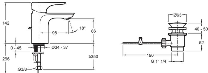
Спецификация продукта: Смеситель для раковины. E78126. Коллекция: GABIN. МАТЕРИАЛ: N/A. ТИП УСТАНОВКИ: 1 отверстие. ТИП: Однорычажный. РАСХОД ВОДЫ: 5 л/мин.
